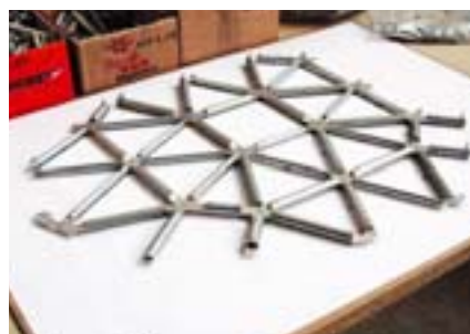
Fertig verstiftetes Obergurt-Modul
