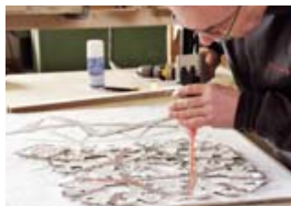
Die Schichten der Aluhaut werden verklebt
