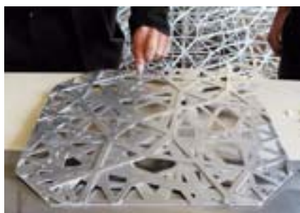
Ein fertiges mehrschichtiges Aluhaut-Modul
